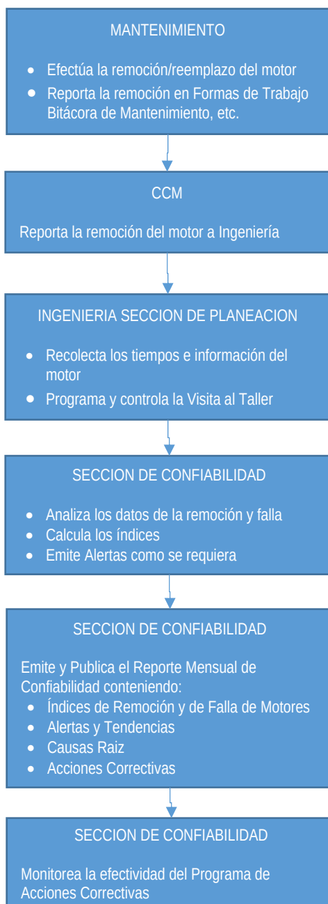
FIG. 3-1-5 RECOLECCION DE DATOS DE REMOCION DE MOTORES
