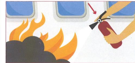
Dirija el flujo a la base del fuego. Direct the flow to the base of the fire.
