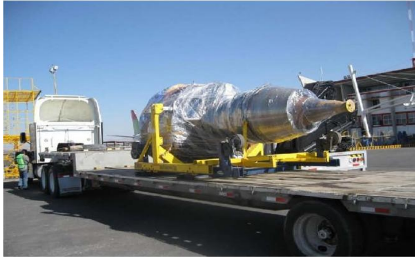
Figura 1 (Orientación adecuada del Motor), Fotografía solo de referencia (Motor CFM)
